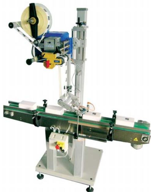
Il Sistema 2 Twist applica etichette autoadesive sulla parte superiore di ogni genere di prodotti. Il nastro di trasporto a velocità fissa, ideale per le applicazioni fuori linea con carico manuale dei prodotti, può essere corredato di un inverter con variatore di velocità per l'inserimento in linea. Dati variabili, codici a barre ed immagini possono essere stampati con l'aggiunta di gruppi stampa idonei.
